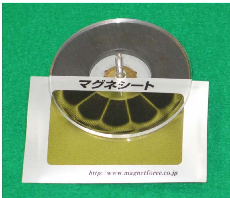
左の画像は、あるリング状磁石の表面に16極（N極とS極を交互に8極ずつ）着磁し、さらにその周囲に多極着磁した複合磁極のパターンを見てみた例です。
